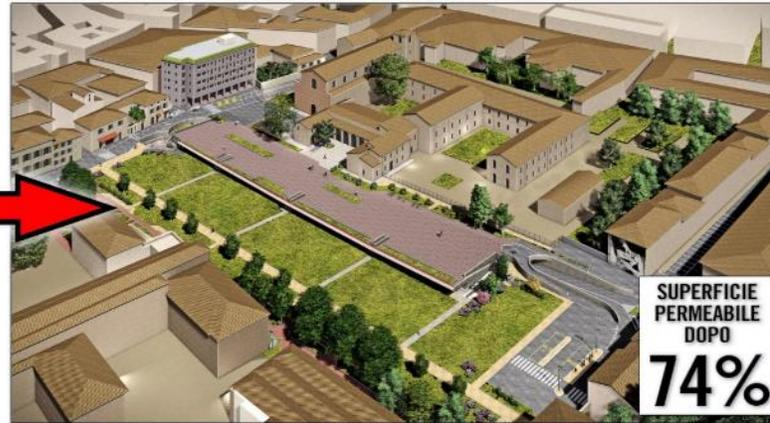
Il progetto prevede la realizzazione di **interventi di de-sealing**: de - sigillazione di superfici impermeabilizzate con ripristino a verde.
