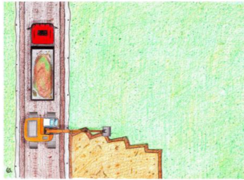
Figure 18. Example of soil stripes removal from a temporary construction track (source: Suolo e cantieri. Stato della tecnica e della prassi UFAM 2015 - disegno L. Bourban)
