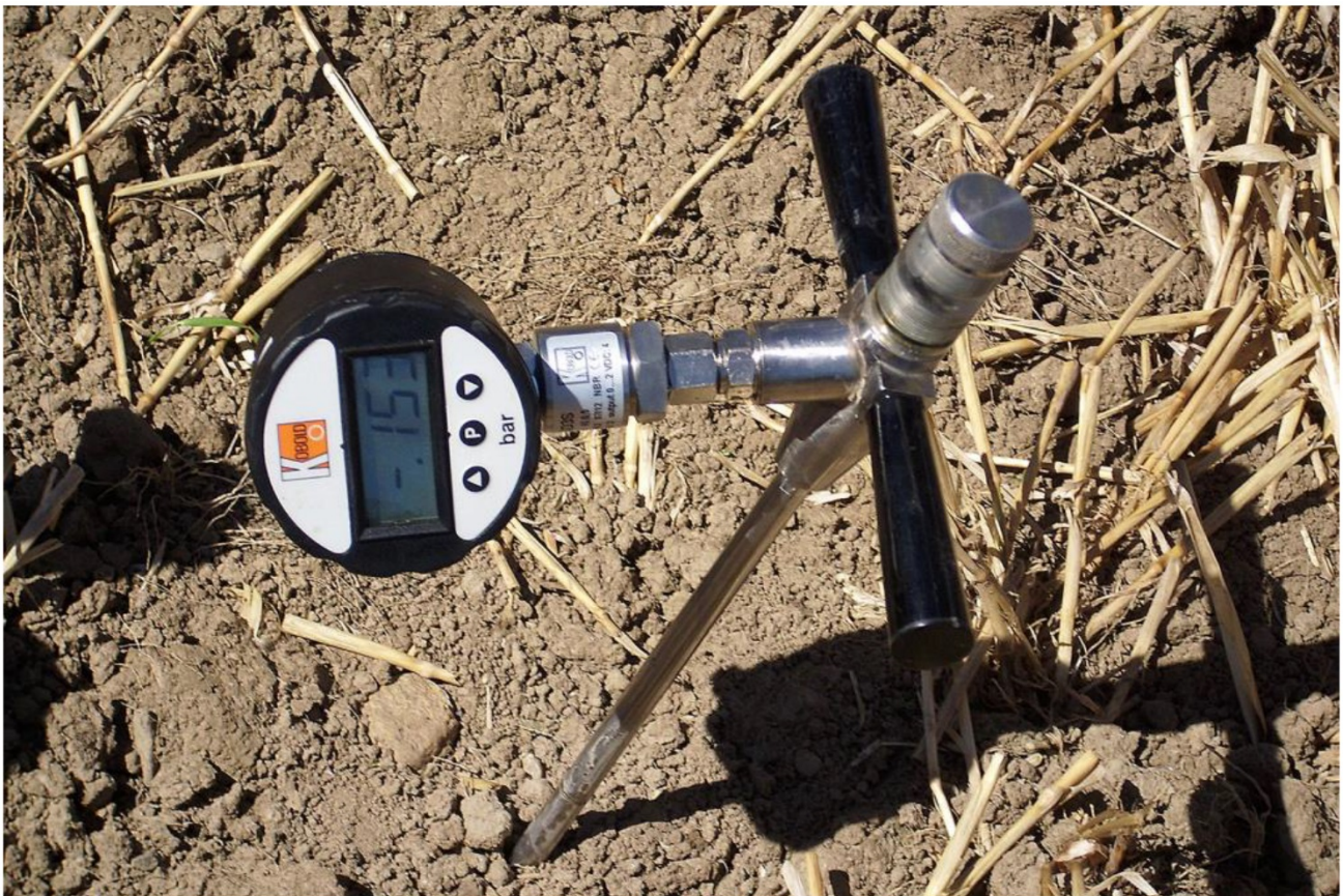
Figura 15. Soil moisture measurement with quick response tensiometer (Source: Suolo e cantieri. Stato della tecnica e della prassi UFAM 2015 - J.P. Clément).
