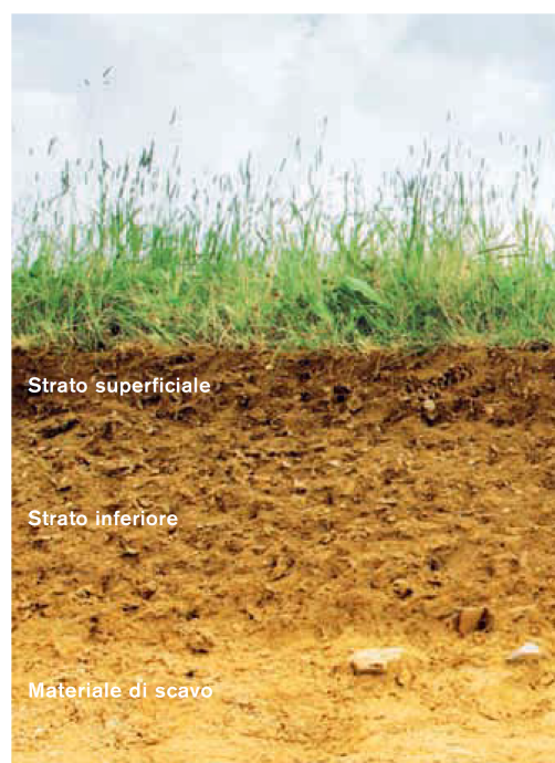
Figura 1. Struttura del suolo fonte: "Per una protezione del suolo efficace in fase di cantiere – Direttive e consigli per la pianificazione" Confederazione Svizzera Ufficio federale dell'ambiente UFAM
