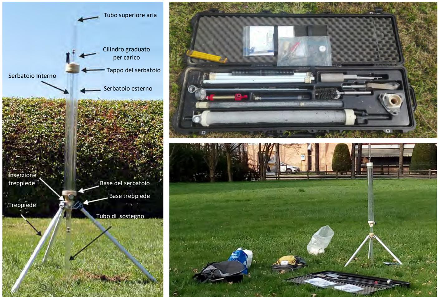
Figura 26. Componenti del permeametro di Guelph
