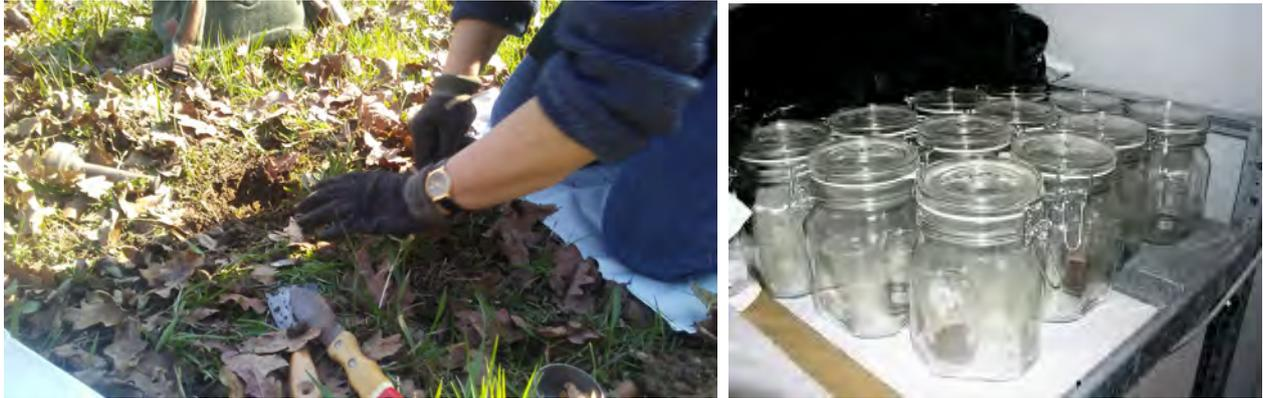
Figura 30. Un momento del campionamento e incubazione dei suoli per analisi di respirazione in laboratorio.
