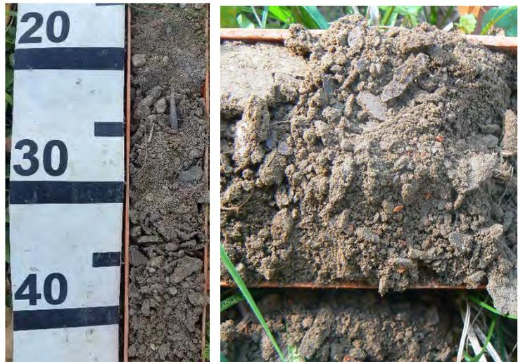
Figura 6. Esempi di trivellate con materiale di riporto e tabella delle profondità raggiunte nella prima fase di rilevamento
